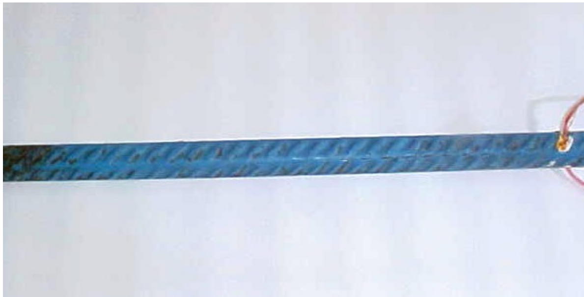
Vue de l'armature revêtue au Fluxal Elek après 400 h d'exposition au brouillard salin
