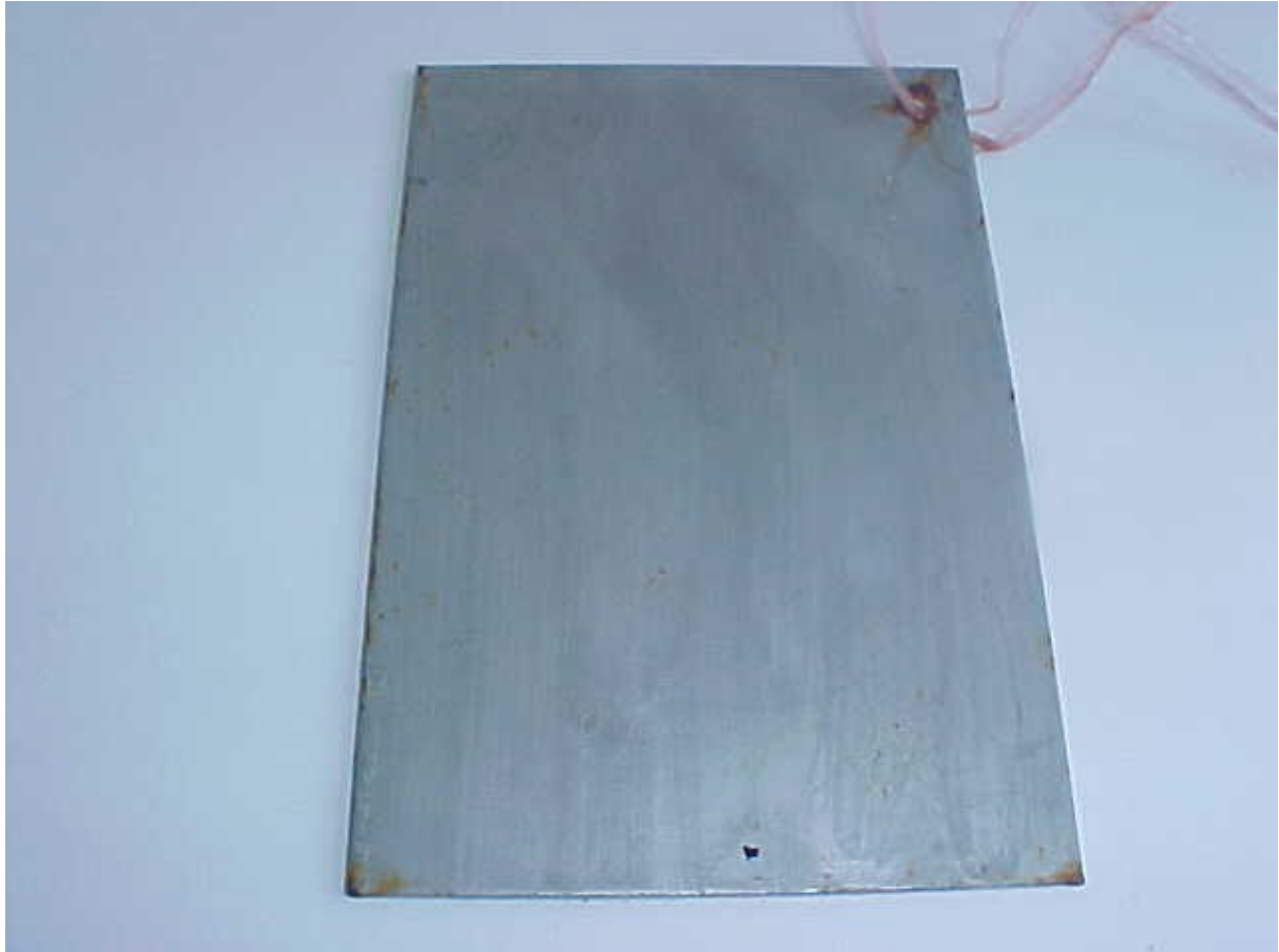
Vue de la plaque revêtue au Fluxal 9707 après 750 h d'exposition au brouillard salin
