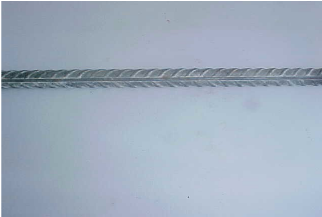
Vue de l'armature revêtue au Fluxal 9707 après 400 h d'exposition au brouillard salin
