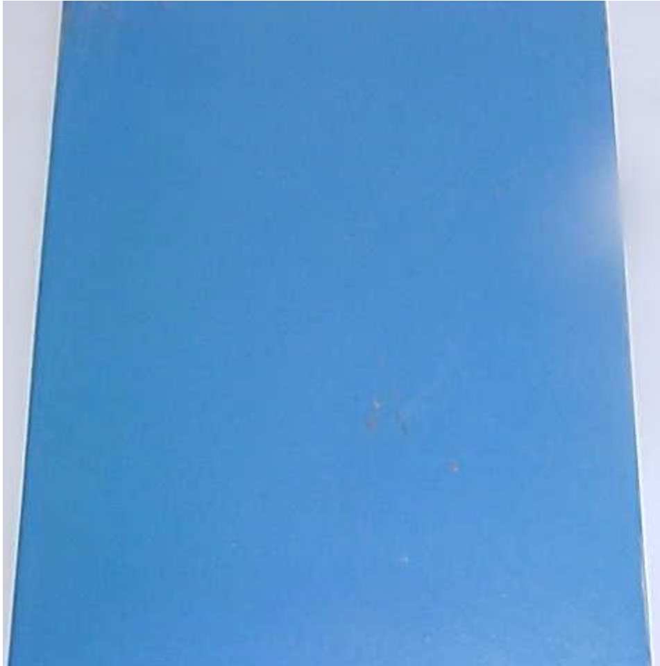
Vue de la plaque revêtue au Fluxal Elek après 200 h d'exposition au brouillard salin
