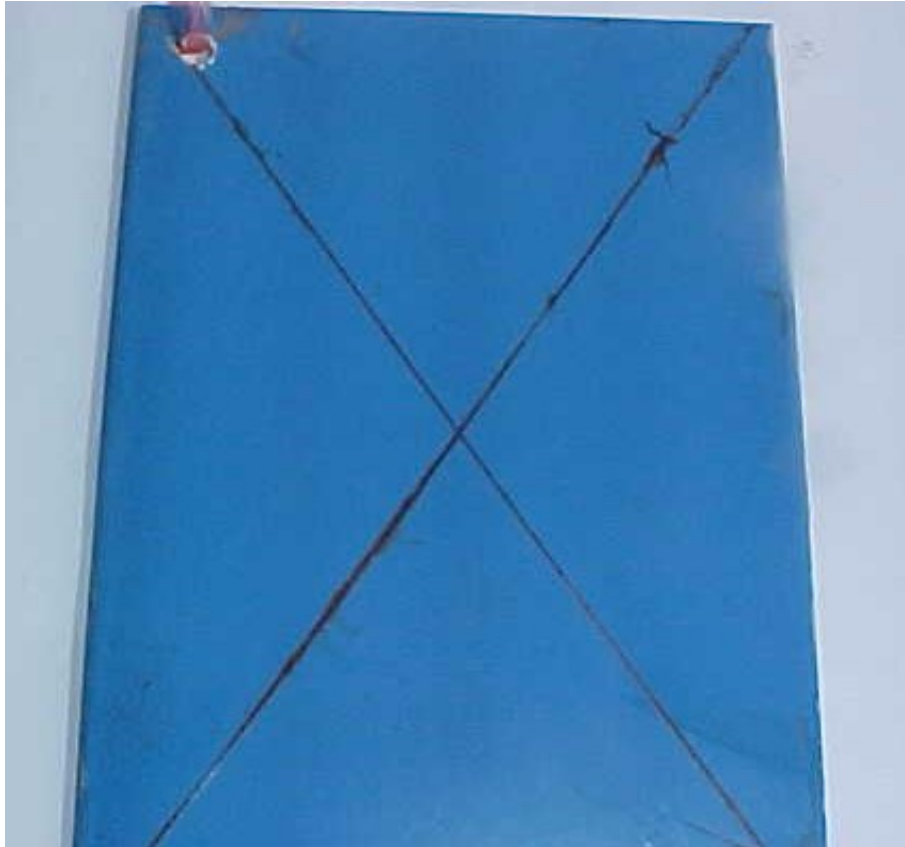
Vue de la plaque revêtue au Fluxal Elek après 950 h d'exposition au brouillard salin (avec incision en X)
