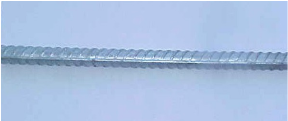
Vue de l'armature revêtue au Fluxal 9707 avant l'essai de brouillard salin
