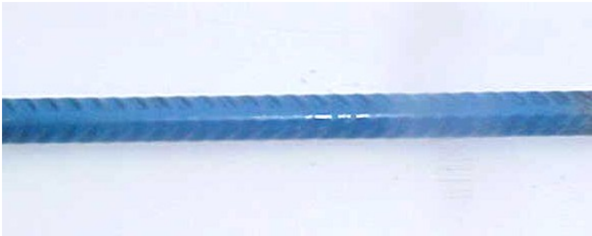
Vue de l'armature revêtue au Fluxal Elek avant l'essai de brouillard salin
