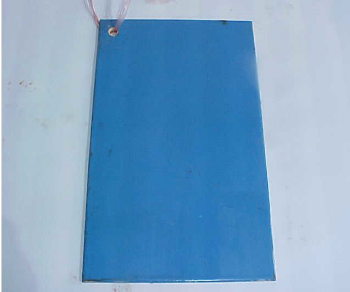
Vue de la plaque revêtue au Fluxal Elek après 500 h d'exposition au brouillard salin.
