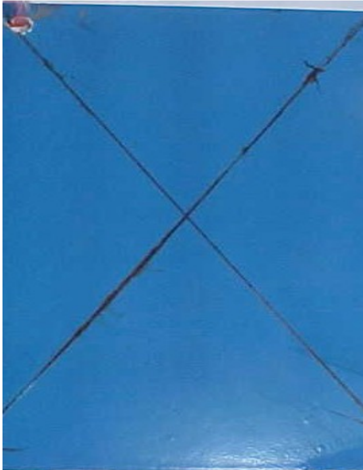
Vue de la plaque revêtue au Fluxal Elek après 500 h d'exposition au brouillard salin (avec incision en X)
