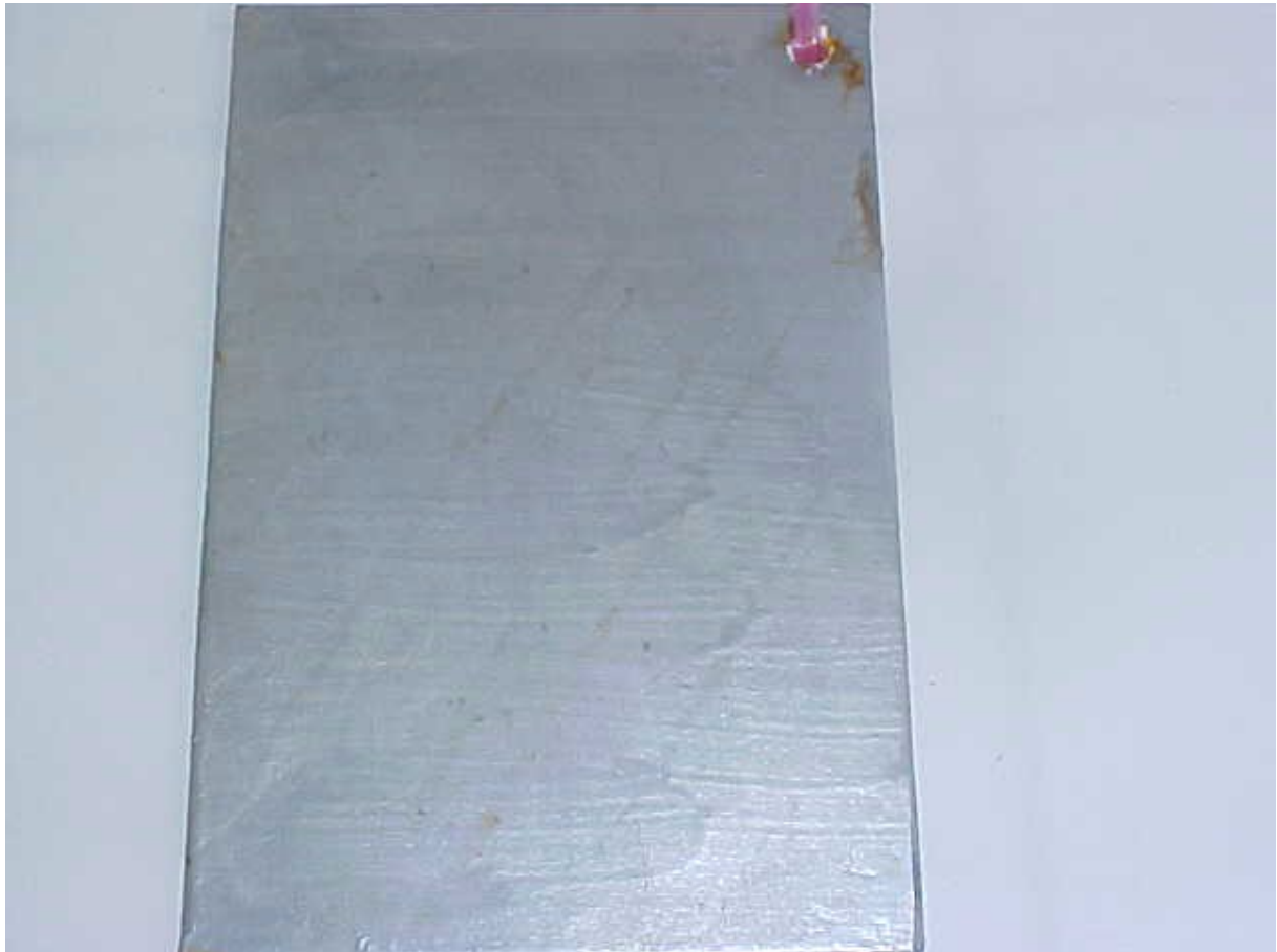
Vue de la plaque revêtue au Fluxal 9707 après 400 h d'exposition au brouillard salin
