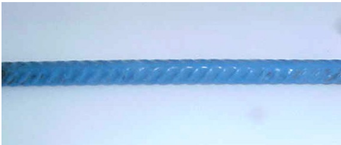
Vue de l'armature revêtue au Fluxal Elek après 950 h d'exposition au brouillard salin
