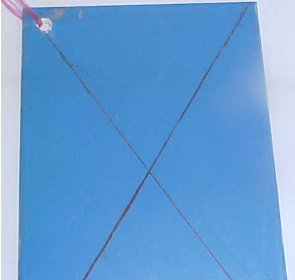
Vue de la plaque revêtue au Fluxal Elek après 200 h d'exposition au brouillard salin (avec incision en X)
