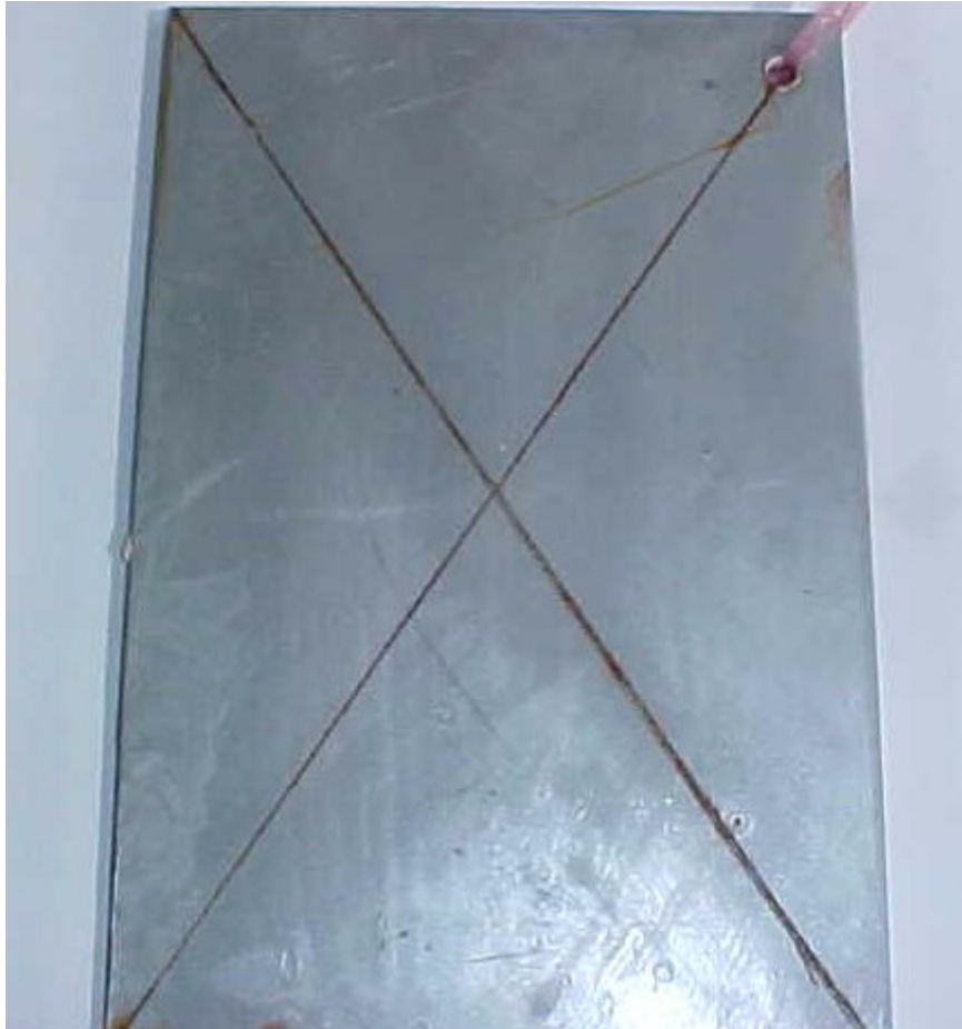
Vue de la plaque revêtue au Fluxal 9707 après 750 h d'exposition au brouillard salin (avec incision en X)
