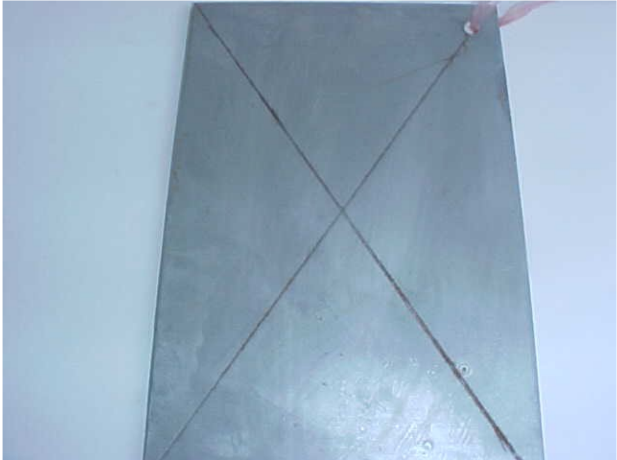
Vue de la plaque revêtue au Fluxal 9707 après 400 h d'exposition au brouillard salin (avec incision en X)
