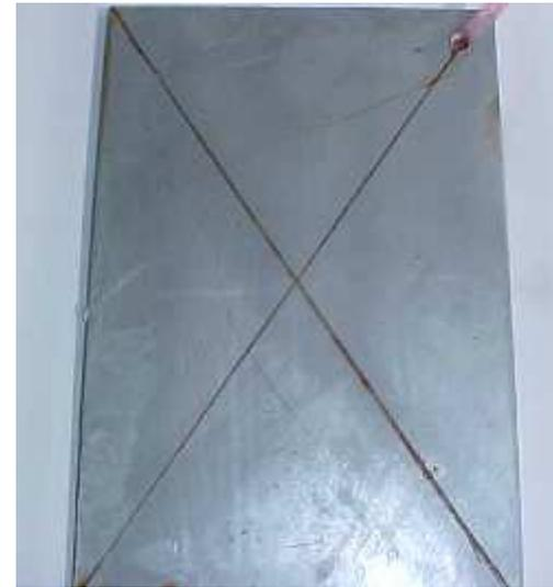
Vue des plaques revêtues de FLUXAL 9707 après 790 Heures d'exposition au brouillard salin
